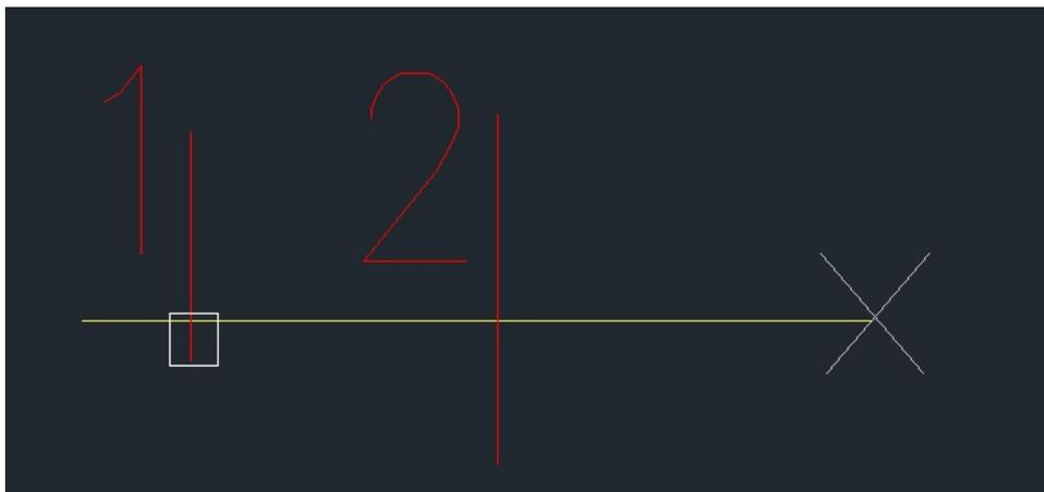
上图，1 支线将从最近点连接至起点，2 支线将从交点连接至起点。
